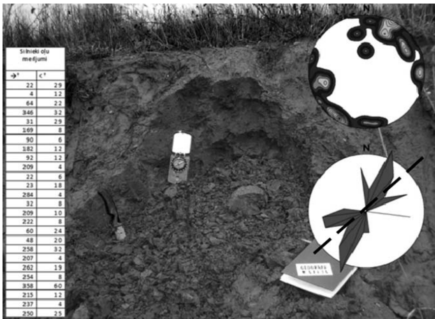
4. att. Oļu linearitātes mērījumi morēnas atsegumā jaunā Silnieku karjera DR sienā. Tie norāda uz ledāja plūsmas virzienu no ZA uz DR. Pārtrauktā līnija norāda paugurmasīva garenass orientāciju.
